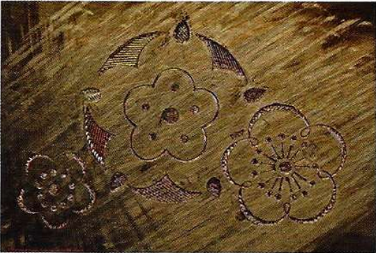
FIGURE 12 Plaque de cuivre gravées au burin, faisant apparaître les surfaces striées, permettant de réaliser des à plats de couleur ou de métaux précieux. Gravure et photographie. Bertrand Novi. Manufacture de Sèvres.
